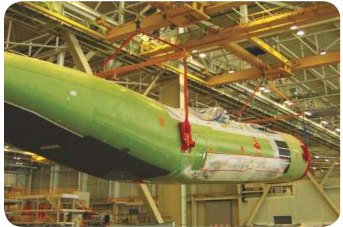
MULTIPLE POINTS UNDERSLUNG TANDEM WORKING CRANES
