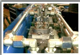
Гидравлические распределители с предохранительными клапанами.
