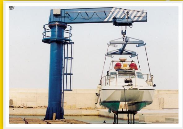
Стандартизация механизмов посредством применения простых модульных конструкций позволяет производить широкий ассортимент кранов с поворотной стрелой грузоподъемностью от 4 до 20 тонн с длиной стрелы до 7 м. Общей характеристикой для таких кранов является простота в использовании и маневрировании.
