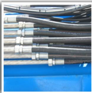
Гидравлические трубы из нержавеющей стали.
