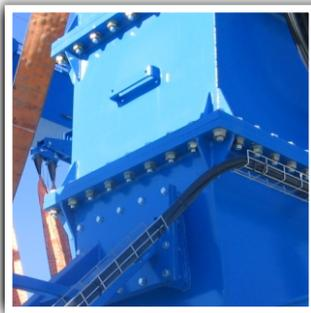
Болтовое соединение для упрощения монтажа.
