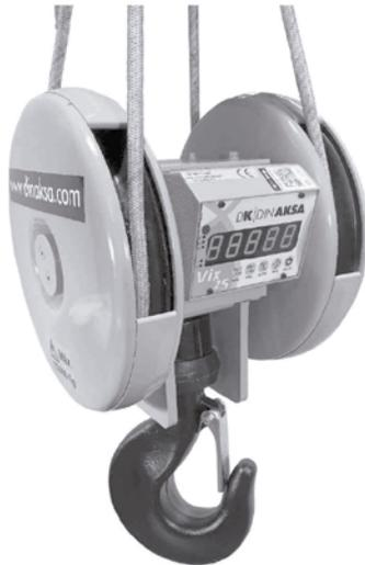
La mouffle peseuse est un système de pesée électronique de haute précision, conçue pour être adaptée à tout type de pont roulant. L'avantage de ce système est qu'il permet de lire la charge levée instantanément, sans avoir à la déplacer vers une balance fixe, avec la particularité de ne pas perdre en hauteur sur la course de levage. Ce système est adaptable à des capacités de charge de 2 000 kg à 250 000 kg.
