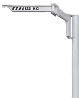
Potence sur fût pour une utilisation en intérieur. Avec une rotation de 180° pour le premier bras et de 300° pour le second bras, ce qui permet de couvrir une grande zone de travail. La portée lorsque les deux articulations sont alignées peut avoir une longueur maximale de 5 m. Conçue pour 150 kg ou 250 kg.
