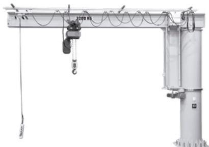
Potence sur fût avec une HSF standard de 3 mètres. Il s'agit d'une potence triangulaire à flèche inversée. Rotation de 360°. Le bras peut avoir une longueur max. de 12 m.
