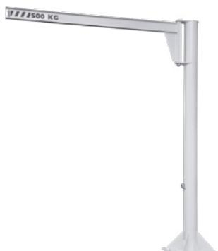
Potence sur fût pour une utilisation en intérieur. Il n'est pas possible de la motoriser. Le bras peut avoir une longueur comprise entre 2 et 7 mètres en fonction de la charge requise. C'est la potence la plus polyvalente lorsqu'il y a des problèmes de hauteur.
