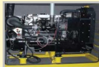
**Bastidor de motor aislado
