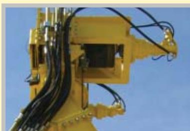
Motores hidráulicos para elevación y dirección de carros,
