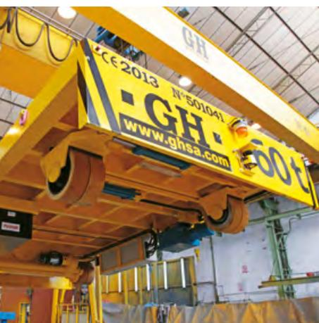
Les chariots de transfert **GH** permettent le mouvement de charges au niveau du sol pour tout type d'industries et d'applications.
