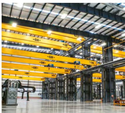
**Pont roulant posé monopoutre**
