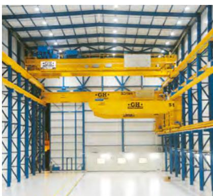
**Pont roulant bipoutre et grue vélocipédique**
