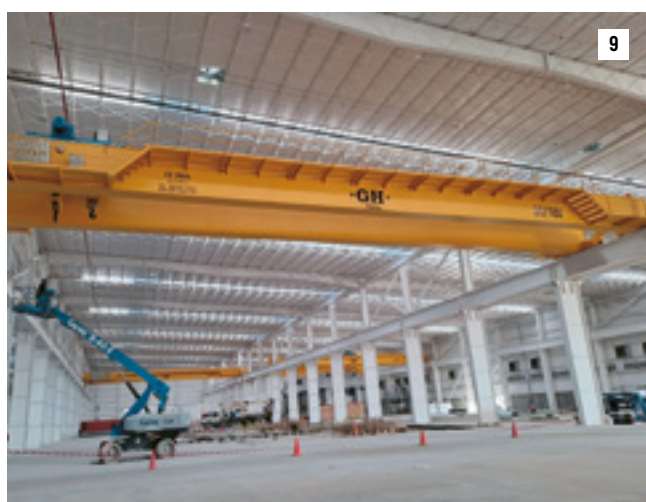
7. San Luis Potosi Grúa Birraíl AUTOMOCIÓN Top running double girder crane. AUTOMOTIVE
