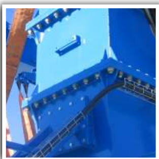
Болтовое соединение для упрощения монтажа.
