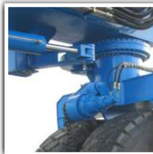
Автоматическое выравнивание руля.
