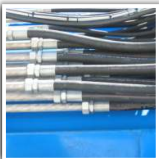
Гидравлические трубы из нержавеющей стали.
