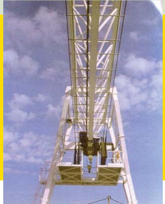
Die Portalkräne mit Gitterwerkstruktur bieten den Vorteil der Reduzierung der dem Wind ausgesetzten Oberfläche und optimieren somit die notwendige Leistung zur Horizontalbewegung.
